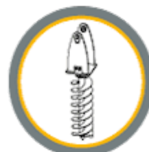
Гидравлический шнековый бур
