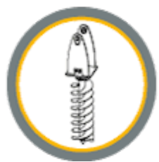
Гидравлический шнековый бур
