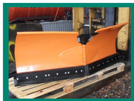
отвал с изменяемой геометрией
