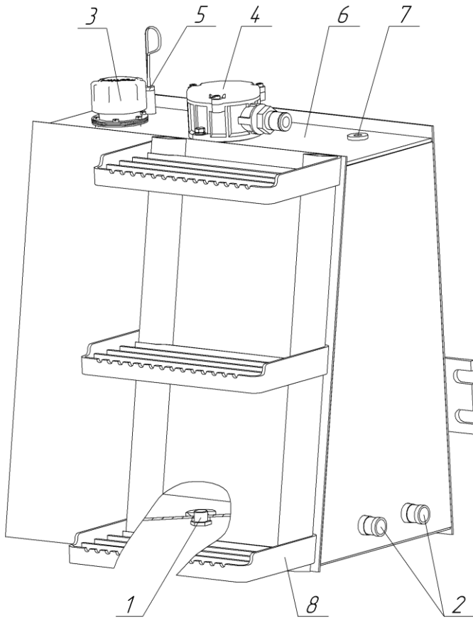
1 – пробка сливная; 2 – патрубки; 3 – заливная горловина; 4 – фильтр сливной 5 – маслоуказатель; 6 – корпус бака; 7 – пробка; 8 – лестница
