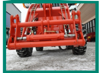
Гидравлический быстросъем с дополнительными гидровыводами
