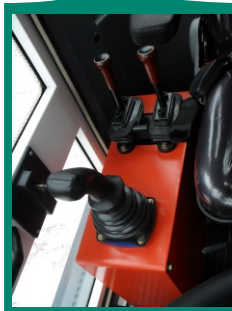
Многофункциональный джойстик для управления рабочими органами погрузчика
