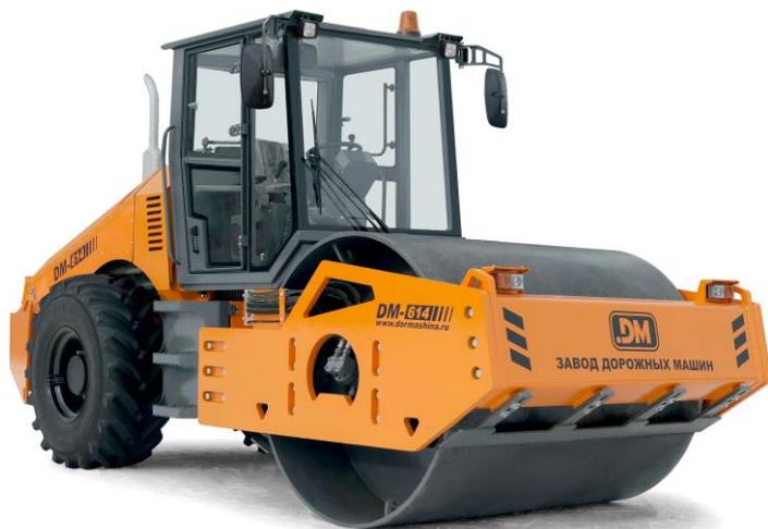
Каток дорожный предназначен для уплотнения грунтов различной степени связности, щебня и гравия при больших и средних объемах работ по устройству оснований на автомобильных, городских дорогах любого типа и категорий, аэродромах, дамбах и промышленных площадках.
