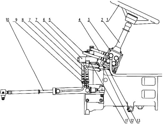
Рис.XX. ГОРУ тракторов серии FT-25 (старого образца для полноприводных моделей). Цифрами обозначены:
