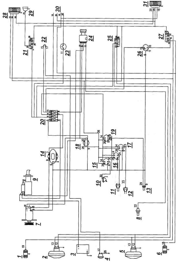
Рис.XX. Схема электрооборудования трактора серии FT-25. Цифрами обозначены:
