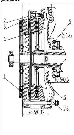
Поворачиванием тяги сцепления (рис.XX) устанавливается свободный ход педали сцепления в пределах 25 ... 30мм. Степень выжима вспомогательного диска сцепления ВОМ регулируется винтом 2.
