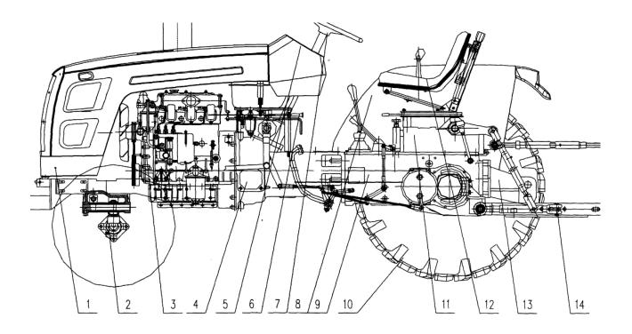
Рис.1. Основные узлы трактора серии FT-25. Цифрами на схеме обозначены:
