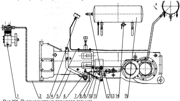
Рис.ХХ. Пневмосистема тормозов (опция).
