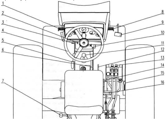
Рис. XX. расположение органов управления тракторов серии FT-25. Цифрами обозначены:
