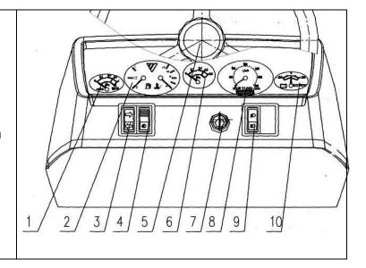
Рис.XX. комбинация приборов нового образца - интегрированная, оснащенная пятью стрелочными приборами — датчиком топлива, температуры охлаждающей жидкости, тахометром, датчиком давления масла двигателя и зарядки АКБ, а также контрольными лампами.
