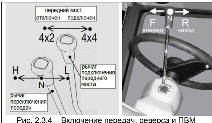
Рис. 2.3.4 – Включение передач, реверса и ПВМ
