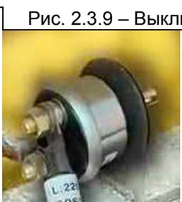
Рис. 2.3.9 – Выключатель аккумуляторных батарей («массы»)
