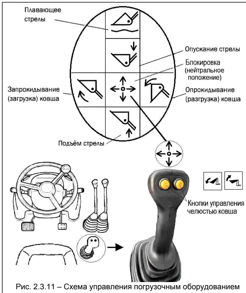
Рис. 2.3.11 – Схема управления погрузочным оборудованием
