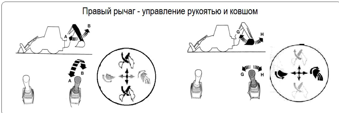
Рис. 2.3.13 – Управление рукоятью и ковшом экскаваторного оборудования
