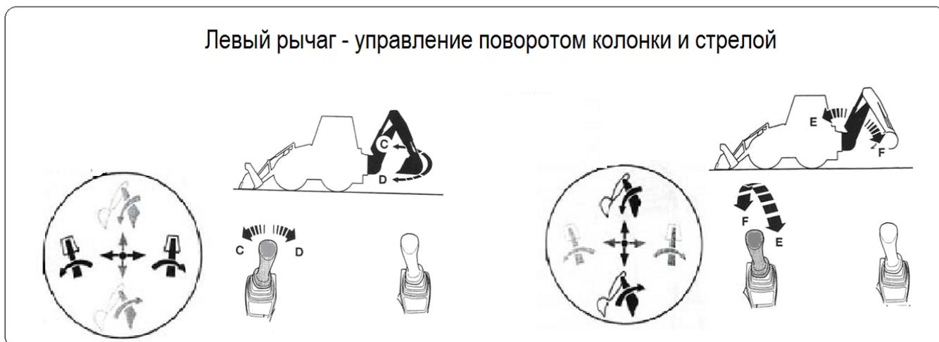
Рис. 2.3.14 – Схема управления поворотом колонки и стрелой экскаваторного оборудования
