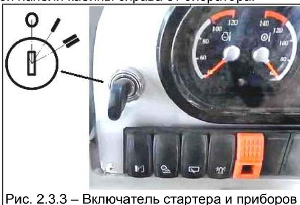
Рис. 2.3.3 – Выключатель стартера и приборов
