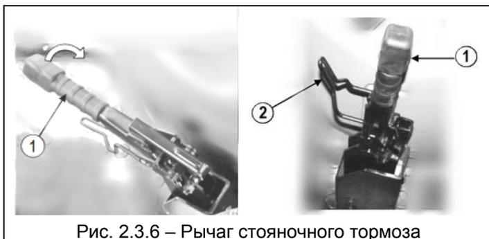
Рис. 2.3.6 – Рычаг стояночного тормоза
