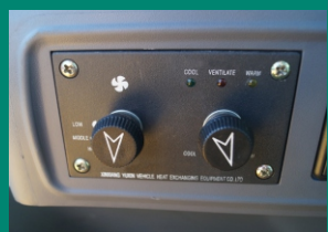
Система вентиляции и кондиционирования воздуха
