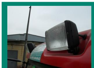
Фонари дополнительного освещения
