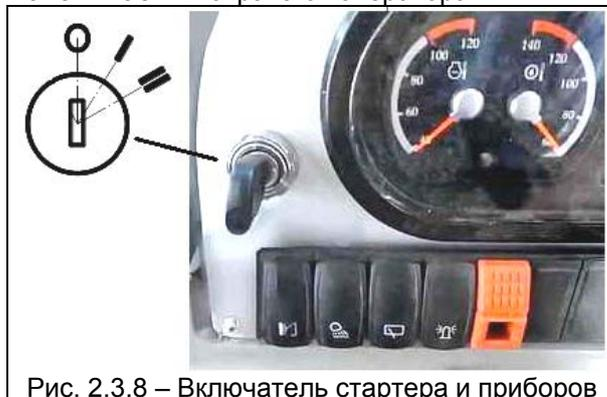
Рис. 2.3.8 – Включатель стартера и приборов
