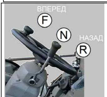
Рис. 2.3.10 – Включение передач и реверса КПП с механическим управлением:
