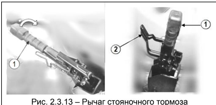
Рис. 2.3.13 – Рычаг стояночного тормоза
