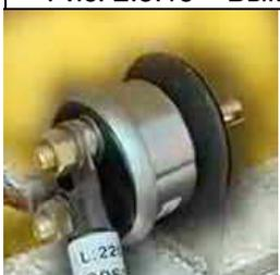
Рис. 2.3.13 – Выключатель аккумуляторных батарей («массы»)
