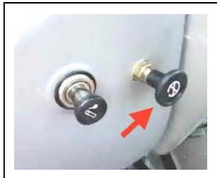
Вариант 1 и 2. Рукоятка тяги механического привода остановки двигателя расположена слева от рулевой колонки на передней панели кабины. Для остановки двигателя необходимо вытянуть рукоятку «на себя» и удерживать до момента прекращения работы двигателя. Привод воздействует на топливный насос высокого давления, подача топлива к форсункам прекращается, и двигатель останавливается. При отпуске рукоятки под воздействием пружины возвращается в исходное положение.
