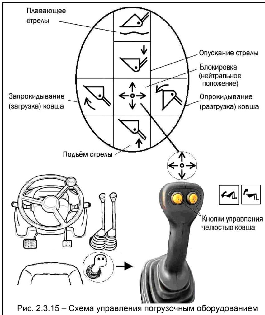
Рис. 2.3.15 – Схема управления погрузочным оборудованием
