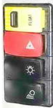
На передней панели кабины расположен блок клавишных выключателей – выключатель аварийной сигнализации, выключатель габаритных огней и ближнего света, выключатель рабочего освещения (передние и задние рабочие фары) и выключатель блокировки управления адаптером сменного фронтального оборудования (обозначен надписью FLOAT).
