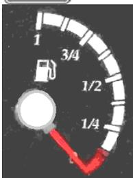
Верхняя граница красной зоны соответствует остатку запаса топлива в баке около 20 литров. При переходе стрелки указателя в красный сектор и включении светового сигнализатора красного цвета с соответствующей пиктограммой оператор должен планировать дозаправку топлива в ближайшее время.
