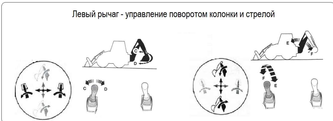
Рис. 2.3.18 – Схема управления поворотом колонки и стрелой экскаваторного оборудования
