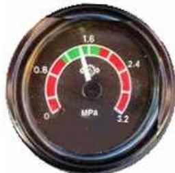
В нормальном режиме работы машины давление жидкости в гидромеханической трансмиссии должно находиться в пределах 1,5 МПа ± 0,1 МПа при температуре от 60 °С до 115 °С.
