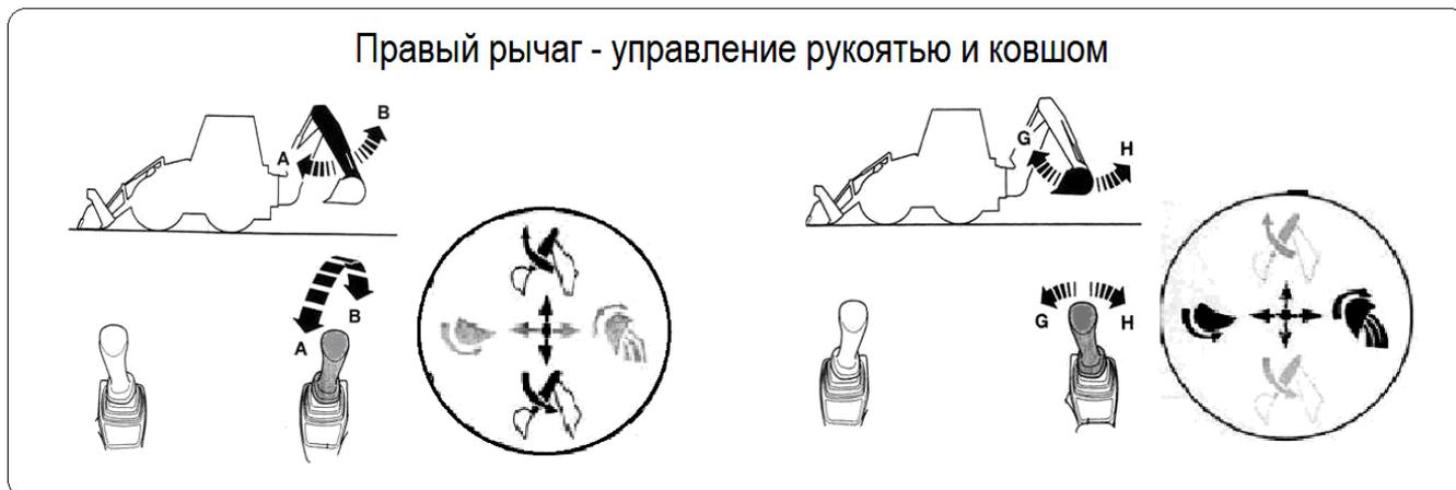
Рис. 2.3.17 – Управление рукоятью и ковшом экскаваторного оборудования
