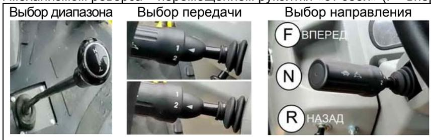
Рис. 2.3.11 – Включение передач и реверса машин вариант 2.
