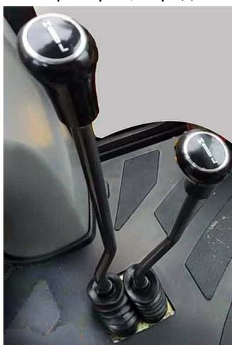
Рычаги передач (H-L) и диапазонов (H-L)
