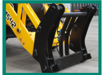
Передний и задний адаптеры (передний – гидравлический, задний – механический; доп. опция)
