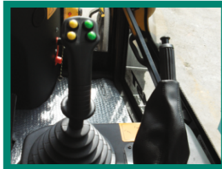
Джойстики управления фронтальным погрузчиком (для моделей M 542 Plus и M 544 Plus)
