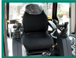
Эргономичное место оператора и джойстики управления экскавационным оборудованием (для моделей M 542 Plus и M 544 Plus)
