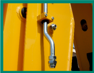
Дополнительная гидролиния на стреле для подключения гидромолота
