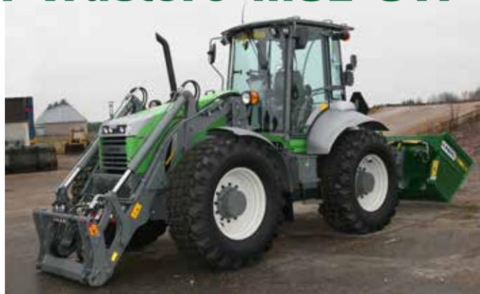
Превосходные скоростные характеристики машины, топливный бак объемом 84 л и экономичность в эксплуатации (расход топлива, составляющий 5–7 л/ч) позволяют говорить о высокой автономности универсальных машин Lännen Lundberg: такие их конструктивные особенности обеспечат непрерывную работу в течение всей рабочей смены оператора с возможностью удаления от базы на значительное расстояние.
